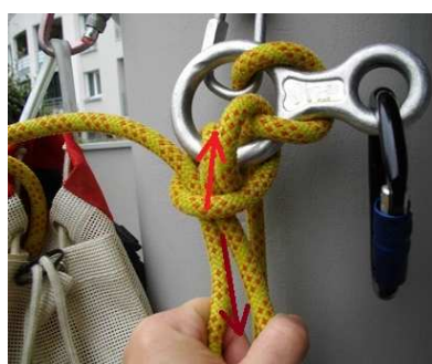
Serrage du nœud de mule
